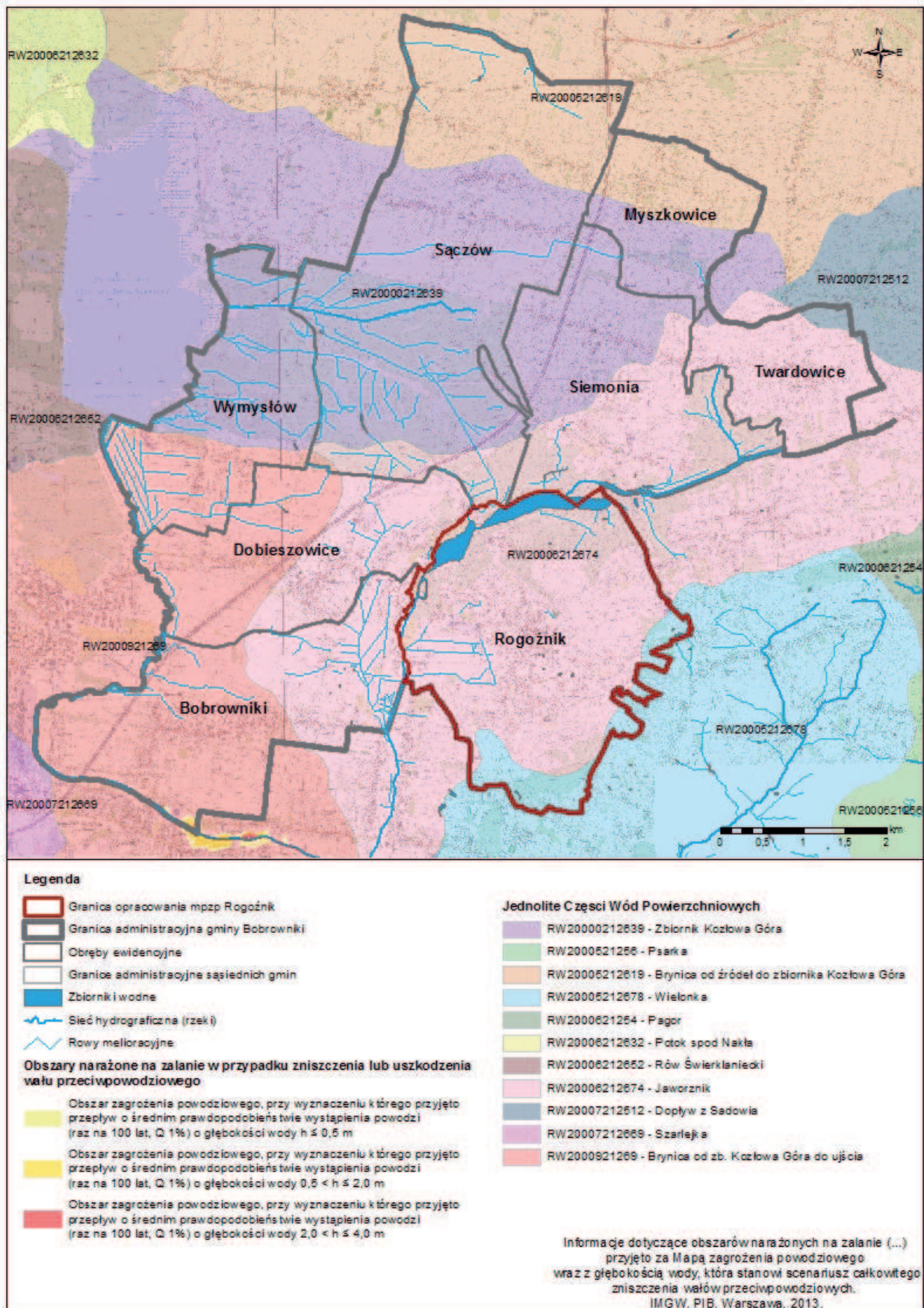
Rysunek 10. Elementy sieci hydrograficznej, Jednolite Części Wód Powierzchniowych oraz obszary narażone na zalanie w przypadku zniszczenia lub uszkodzenia wału przeciwpowodziowego na terenie Gminy Bobrowniki
